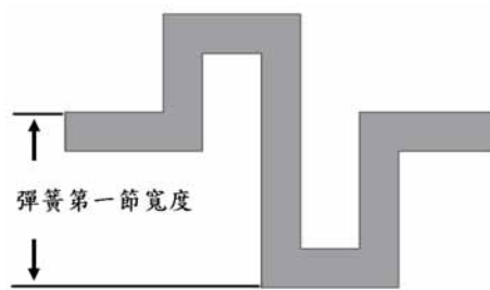
圖 32. 彈簧第一節寬度示意圖
